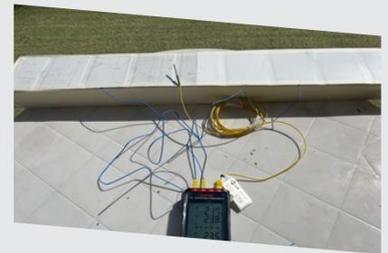
Con data logger, se registra temperatura T1 (con Termiprotec), T2 (Sin Termiprotec) y T4 (Temp Ambiental)
