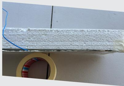
A la cubierta metálica, se adiciona una plancha de poliestireno de 5 cm de espesor
